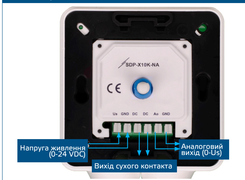
Мал. 1 Електропроводка та з'єднання
