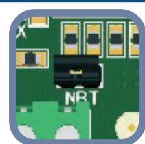
Мал. 5 Перемикач резистора мережевої шини
