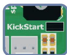
Мал. 6 Перемичка для вибору режиму запуску
