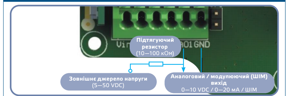
Мал. 5 З'єднання ШІМ (Відкритий колектор)
