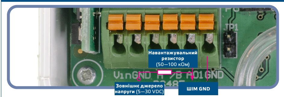
Рис. 6 Підключення ШІМ (з відкритим колектором) (JP1 відключений)
