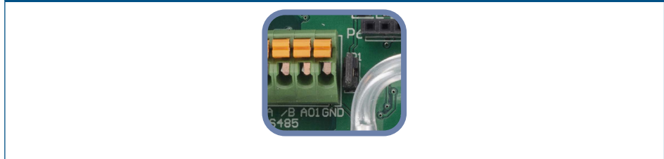
Мал. 5 Сполучна перемичка резистора підключена
