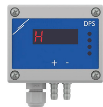
7 б Індикація скидання Modbus
