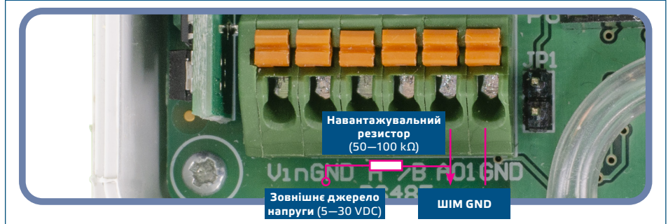
Рис. 6 Підключення ШІМ (з відкритим колектором) (JP1 відключений)
