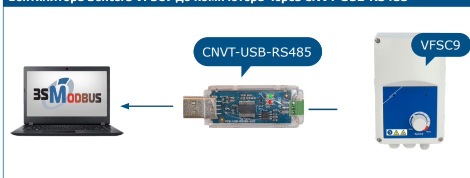
Мал. 1 Приклад підключення електронного регулятора швидкості вентилятора Sentera VFSC9 до комп'ютера через CNVT-USB-RS485
