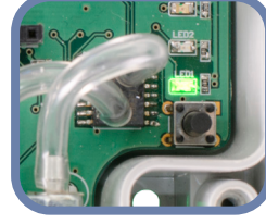
Şek. 16 Güç/Modbus iletişim göstergesi
