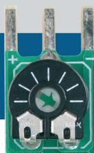
PTV düzenleyicili potansiyometreler, bir analog girişi ile çalışan elektronik fan hızı kontrolörleri için giriş sinyalini ayarlamakta kullanılabilir. İki ürün versiyonu bulunmaktadır: 5 mm aralıklı standart bir terminal bloğuna monte etmek için PTV-X05.0 ve 10 mm aralıklı standart bir terminal bloğuna monte etmek için PTV-X10.0.
