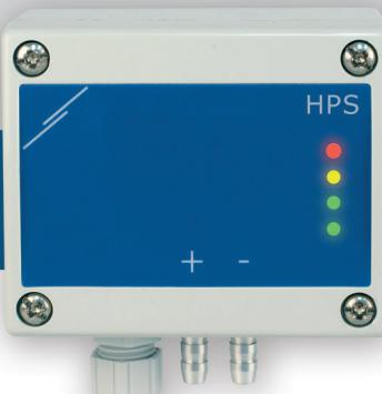
HPS -2 serisi, geniş bir uygulama yelpazesi için tasarlanmış tamamen dijital bir basınç dönüştürücüyle donatılmış fark basınç vericileridir. Hava hızı okuması, harici bir Pitot tüpü bağlantı seti bağlanarak elde edilebilir. Tüm parametrelerle Modbus RTU üzerinden erişilebilir.(3SModbus yazılımı veya Sensistant). Ayrıca entegre K faktörü ve analog / modülasyon çıkış (0–10 VDC / 0–20 mA / 0–100 % PWM) içerirler.
