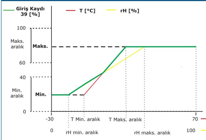
**Not:** Çıkış, T ve rH değerlerinden en yüksek olanına bağlı olarak otomatik olarak değişir, yani iki çıkış değerinden en yüksek olanı çıkışı kontrol eder. Yukarıdaki çalışma şemasındaki yeşil çizgiye bakınız. Bir veya birden fazla sensör devre dışı bırakılabilir. Örneğin, çıkışı sadece ölçülen sıcaklık değerlerine göre kontrol etmek de mümkündür.
