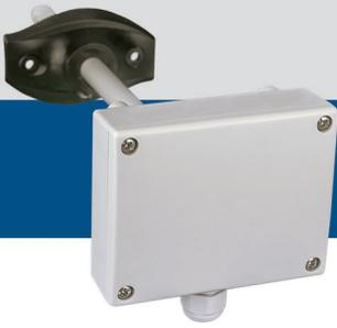
DCTHM-2 serisi, ayarlanabilir sıcaklık ve bağıl nem aralıklarına sahip akıllı sensörlerdir. Kullanılan algoritma, ölçülen sıcaklık ve bağıl nem seviyelerine dayalı olarak bir EC fanını, bir AC fan hız kontrol cihazını veya aktüatörle çalışan bir damperi doğrudan kontrol etmek için kullanılacak bir çıkış değeri üretirler. Modbus üzerinden güç sağlanır ve tüm parametrelere Modbus RTU üzerinden erişilebilir.
