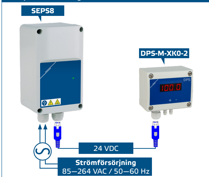
Exempel 1: Anslutning via RJ45-kontakter
