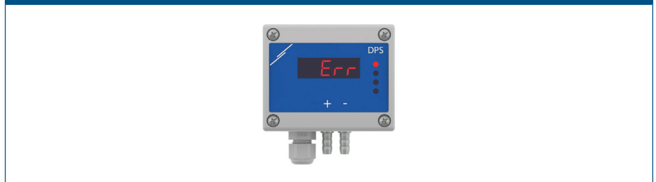
Fig. 13 Fel på sensorelement
