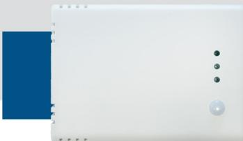
RCMFX-3 är intelligenta multifunktionella rumsgivare med justerbara intervall för CO<sub>2</sub>, temperatur och relativ luftfuktighet. Deras algoritm styr en analog/modulerande utgång baserat på de uppmätta CO<sub>2</sub>-t, T- och rh-värdena, som kan användas för att direkt styra en EC-fläkt, en AC-fläkthastighetsregulator eller ett ställdonsdrivet spjäll. Alla parametrar är tillgängliga via Modbus RTU.
