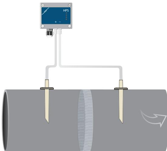
**Tillämpning 2:** Reglering av tillfört luftflöde [ $\text{m}^3/\text{h}$ ] eller lufthastighet [m/s] med PSET-PT
