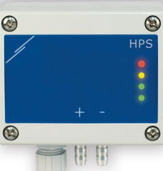
HPS-M--LP-serien är differenstryckgivare (-125–125 Pa) som är utrustade med en helt digital trycksensor konstruerad för olika tillämpningar. Avläsning av lufthastighet är tillgänglig genom att ansluta en extern pitotrör anslutningssats. Matningen händer via Power over Modbus och parametrar är tillgängliga via Modbus RTU (3SModbus-programvara eller Sensistant).
