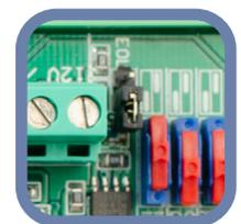
Регистры Modbus можно сбросить, нажав тактовый переключатель в течение 4 секунд (см. Рис. 8).
