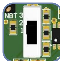
Рис. 5 Перемычка для выбора режима аналогового выхода
