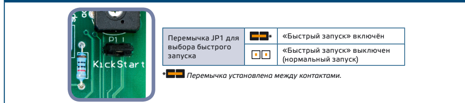
Fig. 4 Перемычка для выбора запуска
