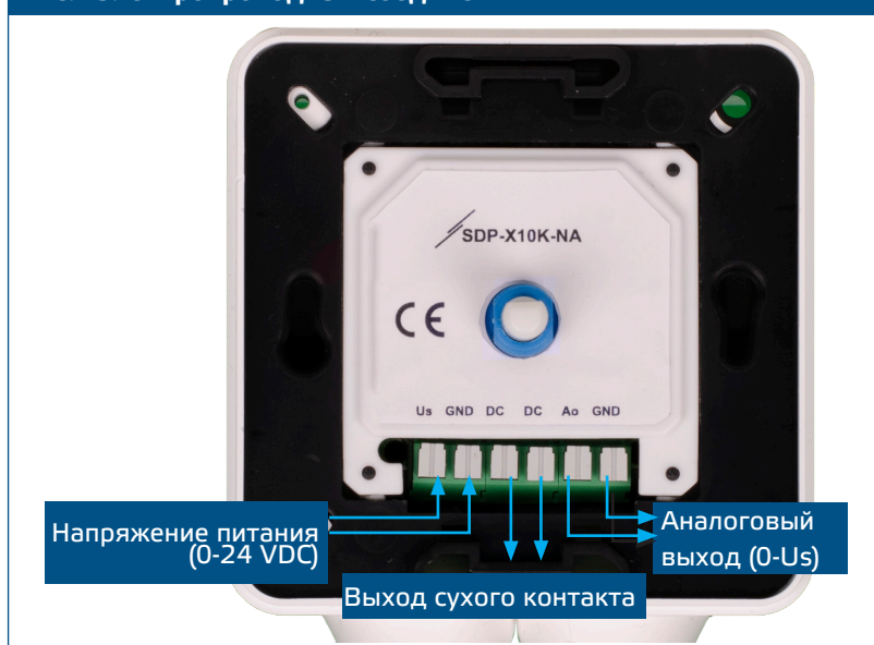
Рис.1 Электропроводка и соединения
