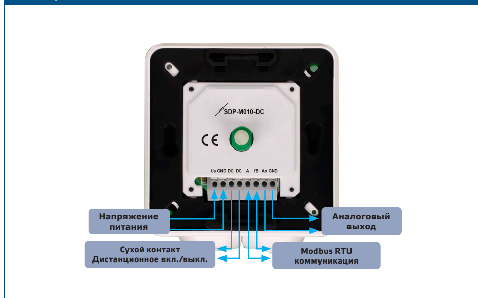
Рис.1 Проводка и соединения
