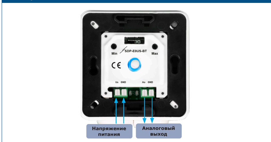
Рис.1 Проводка и соединения
