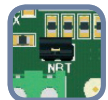
Рис. 5 Оконечный резистор шины
