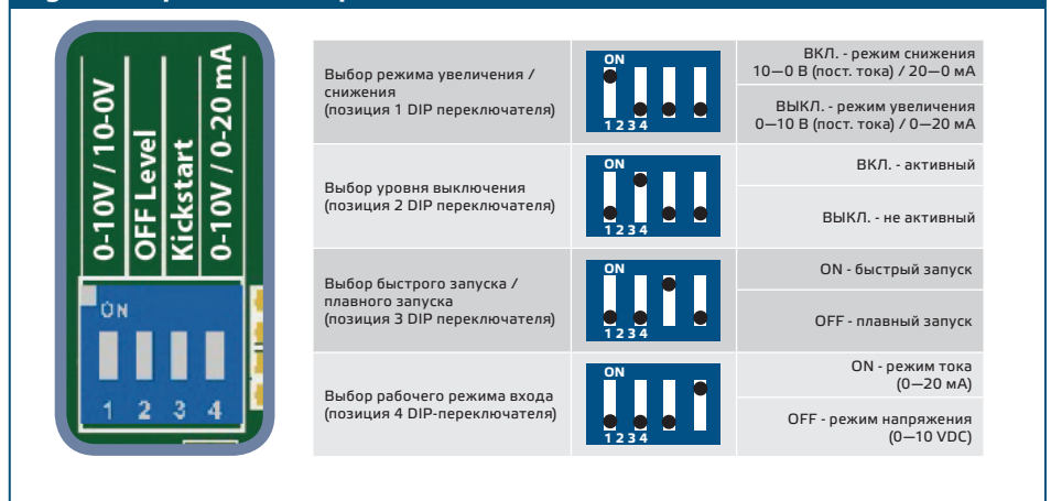
Fig. 4 Настройки DIP-переключателя
