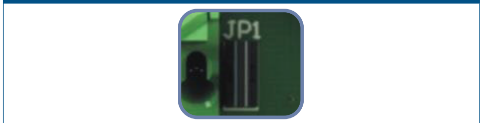
Рис. 4 Перемычка нагрузочного резистора
