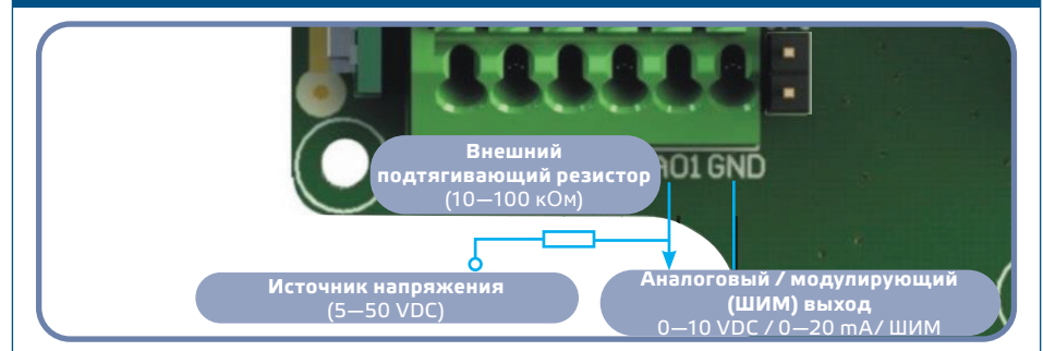
Рис. 5 Соединение ШИМ (открытый коллектор)
