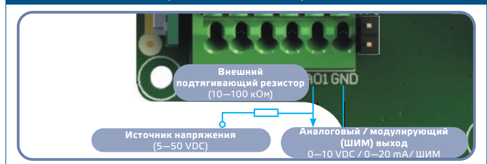
Рис. 5 Соединение ШИМ (открытый коллектор)
