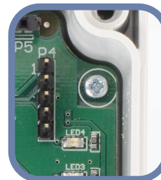
Рис. 10 Перемычка сброса регистров Modbus
