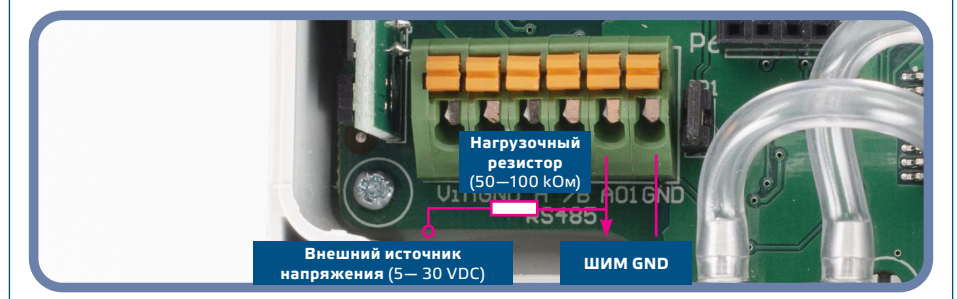
Рис. 6 ШИМ (открытый коллектор) подключение
