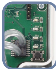
Рис. 9 Светодиодная индикация связи
