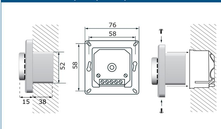
**Рис. 3** Монтажное положение
