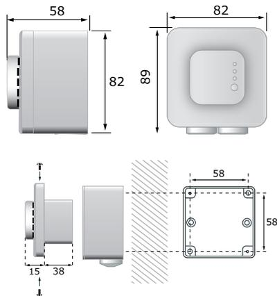
**Рис. 5 Монтажное положение**
