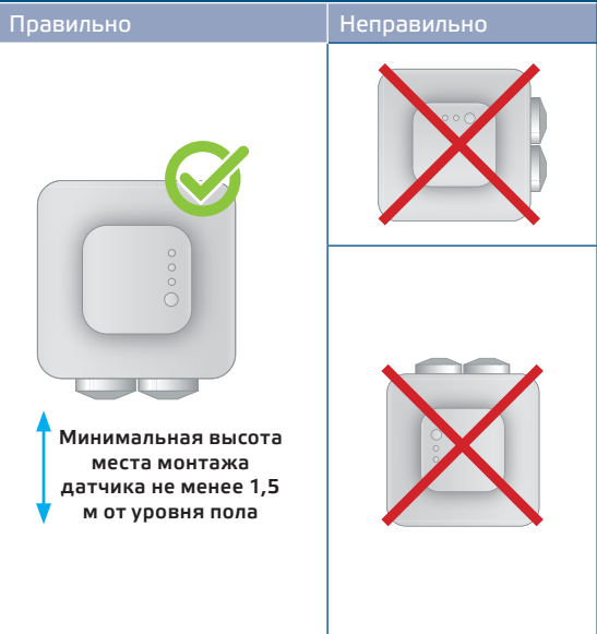
Рис. 5 Монтажное положение
