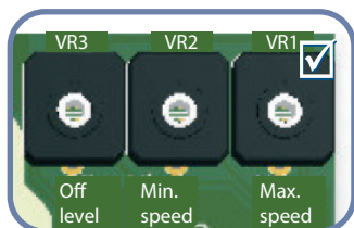
Рис.6 Подстроечный резистор макс. скорости
