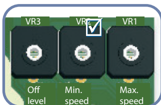
Рис. 7 Подстроечный резистор мин. скорости
