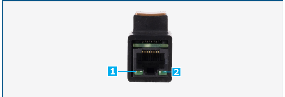
Рис. 4 Светодиодная индикация связи
