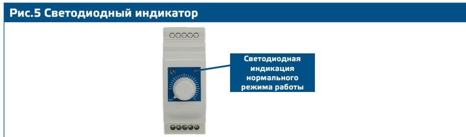
7. Установите необходимое выходное напряжение с помощью потенциометра на передней крышке. Отрегулируйте минимальную скорость с помощью триммера (при необходимости), согласно инструкциям на **рис. 6**. Заводская установка минимального напряжения составляет 100 VAC. Минимально допустимое напряжение двигателя зависит от типа двигателя и области применения. Слишком низкое напряжение двигателя может нанести вред двигателю.
