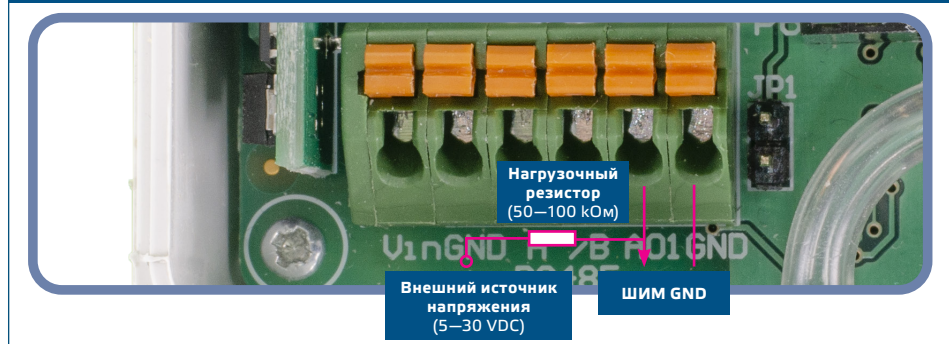
Рис. 6 Подключение ШИМ (с открытым коллектором) (JP1 отключен)
