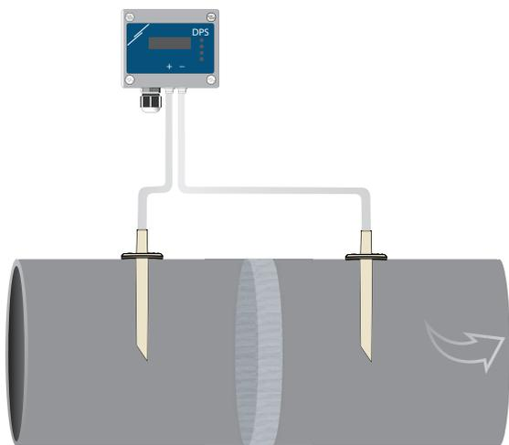
**Пример применения 2:** Измерения объемного расхода \ [м<sup>3</sup> / ч] или скорости воздуха \ [м / с] с помощью PSET-PT
