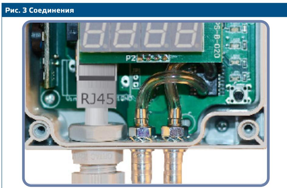
5. Подсоедините штуцер датчика к воздуховоду (см. **Рис. 4**). В зависимости от применения Вы должны использовать определенный набор трубок для соединения штуцера датчика с воздуховодом:
