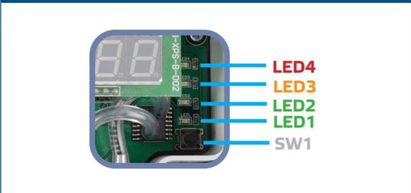
**Рис. 9 Индикация калибровки и сброса параметров Modbus-a**
