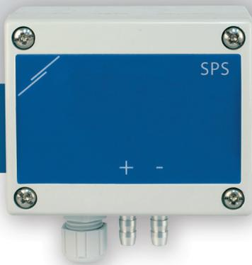
Регулятор дифференциального давления SPS2 управляет непосредственно ЕС вентиляторы, инверторы частоты или другие элементы с двумя заданными уставками дифференциального давления (высокий / низкий или день / ночь режимы). Он имеет аналоговый или цифровой выход с ПИ-регулированием и настройкой К-фактора. Уставки могут переключаться с помощью внешнего переключателя / или в цифровом виде. Все рабочие параметры могут устанавливаться с помощью Modbus RTU.
