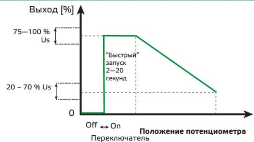
**Примечание:** По умолчанию, желаемая скорость вращения вентилятора или выходное значение устанавливаются с помощью встроенного потенциометра. Благодаря модульной конструкции можно впоследствии соединить датчики между собой через связь Modbus RTU.
