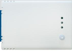
RSMFM-3 - это многофункциональный комнатный датчик, который измеряет уровень концентрации CO<sub>2</sub>, температуру, относительную влажность и окружающее освещение. Питание осуществляется по Modbus, а все параметры доступны через Modbus RTU.
