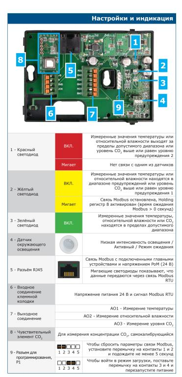
**Примечание:** По умолчанию светодиодные индикаторы визуализируют измеренный уровень  $\mathrm{CO}_2$ . Когда датчик находится в режиме обновления прошивки, зеленый и желтый светодиоды мигают попеременно. Во время загрузки прошивки дополнительно мигает красный светодиод.
