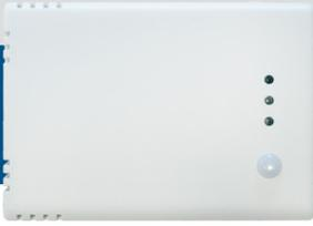
Серия RSMFH-3 - это многофункциональные комнатные датчики, которые измеряют концентрацию CO<sub>2</sub>, температуру, относительную влажность и окружающее освещение. Они имеют три аналоговых / модулирующих выхода для измерения температуры, относительной влажности, уровня концентрации CO<sub>2</sub>, источник питания 24 В. Доступ ко всем параметрам можно получить через Modbus RTU.
