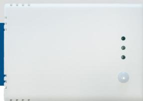
RCTHX - это интеллектуальные датчики с регулируемыми диапазонами температуры и относительной влажности. Алгоритм управляет одним аналогово/модулирующим выходом на основе измеренных значений температуры и влажности, который можно использовать для прямого управления ЕС-вентилятором или заслонкой с приводом. Все параметры доступны через Modbus RTU.
