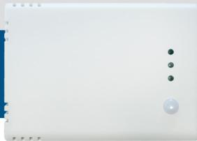
RCTHX - это интеллектуальные датчики с регулируемыми диапазонами температуры и относительной влажности. Алгоритм управляет одним аналогово/модулирующим выходом на основе измеренных значений температуры и влажности, который можно использовать для прямого управления EC-вентилятором или заслонкой с приводом. Все параметры доступны через Modbus RTU.
