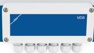
MDB-M / 6 представляет собой компактную распределительную коробку PoM. Она совместима с датчиками, контроллерами ОВК и регуляторами скорости вращения вентиляторов с Modbus RTU и подходит для передачи данных на большие расстояния и распределения данных между подключенными устройствами.
