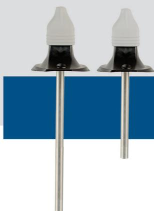
Серия DTS-M - это датчики температуры с питанием от Modbus 24 VDC через разъем RJ45. Они предназначены для воздуховодов и совместимы с различными системами регулирования температуры. Чувствительный элемент размещен в трубке из нержавеющей стали, что упрощает очистку системы воздуховодов. Есть две версии продукта в зависимости от длины трубки - 85 и 165 мм.
