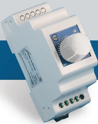
Серия DRX - это электронные регуляторы скорости для AC вентиляторов с однофазным двигателем, регулируемым напряжением. С помощью поворотной ручки на передней панели регулируемое напряжение можно установить от высокого до низкого. Повернув ручку полностью влево (положение Off), мотор можно выключить. Триммер позволяет оптимизировать минимальную скорость для конкретного приложения. Корпус подходит для монтажа на DIN-рейку.
