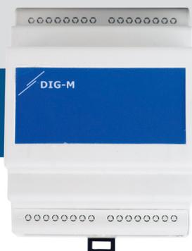
Интернет-шлюз DIG-M-2 - это устройство, предназначенное для подключения устройств Sentera к интернету с целью их мониторинга и настройки через SenteraWeb. Устройство имеет 2 канала Modbus RTU - подчиненный канал, к которому подключены устройства Sentera, и главный канал для подключения главного контроллера или BMS. Его можно подключить к интернету через Ethernet или Wi-Fi.
