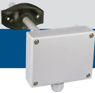
DCTHX-2 это интеллектуальные датчики с регулируемыми диапазонами температуры и относительной влажности. Их алгоритм управляет одним аналоговым / модулирующим выходом на основе измеренных значений T и rH, который может использоваться для непосредственного управления ЕС вентилятором или приводом заслонки. Все параметры доступны через Modbus RTU.
