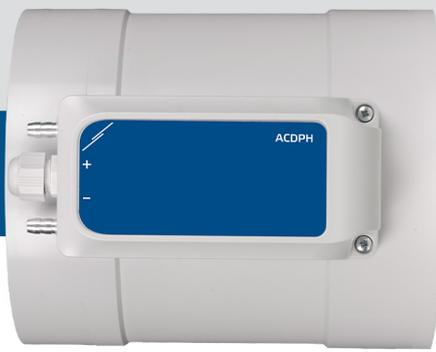
Серия ACDPH - это круглые моторизованные заслонки со встроенным регулятором перепада давления, которые регулируют поток воздуха в системах воздуховодов. Они измеряют статическое давление в одной точке воздуховода, и когда давление, объемный расход или скорость воздуха изменяются, это компенсируется регулировкой положения лопасти демфера для достижения желаемого давления. Так обеспечивается комфортная вентиляция. Напряжение питания составляет 24 VDC. Все параметры доступны через связь Modbus RTU.
