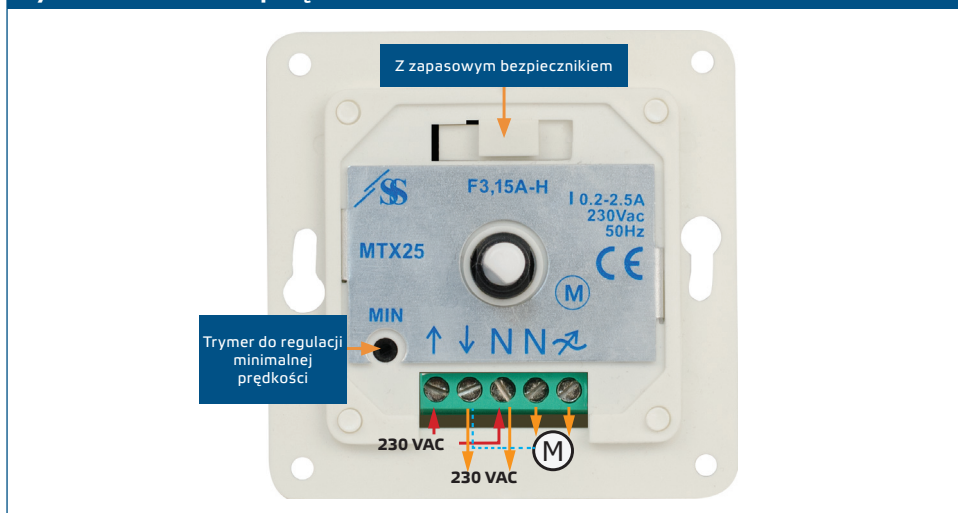
Rys.1 Okablowanie i połączenia
