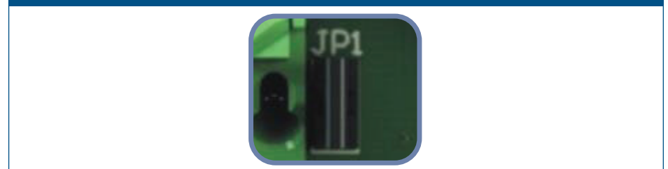
Rys. 4 Zworka rezystora podciągającego 1
