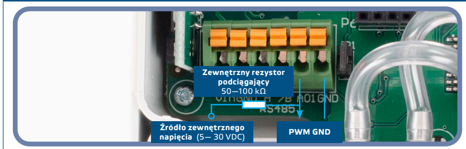
Rys. 6 Połączenie PWM (otwarty kolektor)
