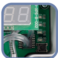
Rys. 8 Kalibracja czujnika i przełącznik taktowy resetowania rejestru Modbus i wskazania
